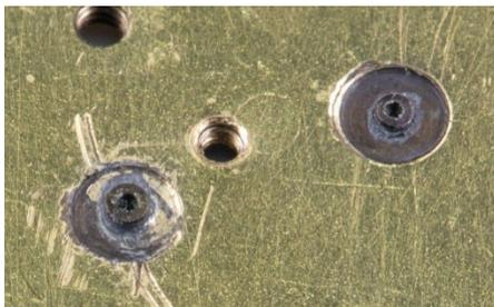
Figure 54: vue intérieure des bouchons avec étain
