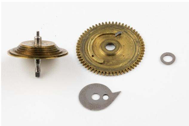
Figure 22: les éléments de la fusée
