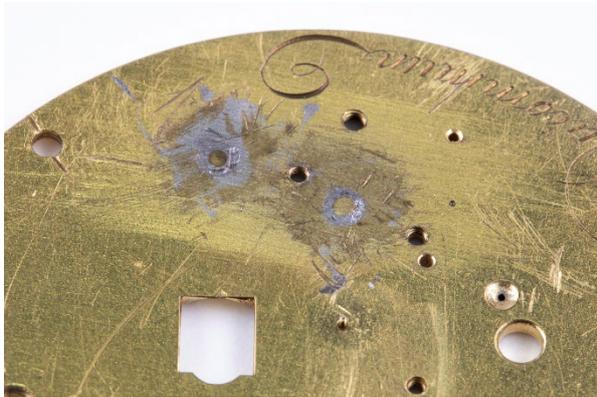
Figure 59: vue extérieure platine avec bouchons et étain
