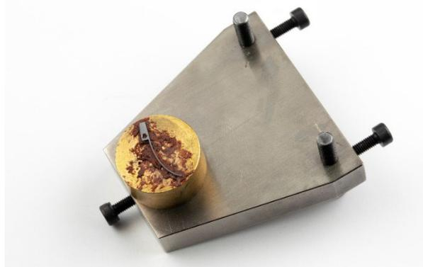
Figure 89: ressort monté sur tripode et fixé à la cire
