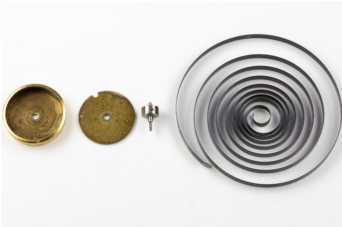
Figure 20: les éléments du barillet
