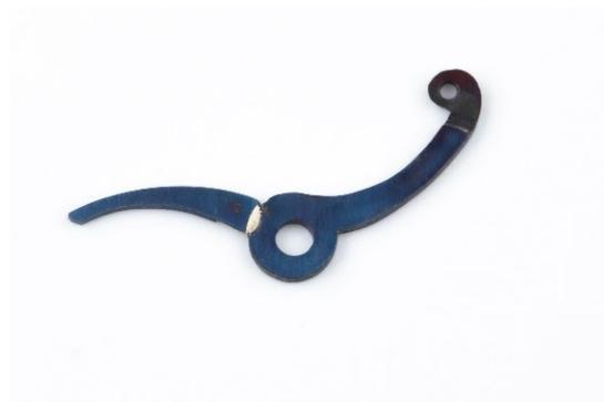
Figure 85: levier assemblé et brasé à l'argent
