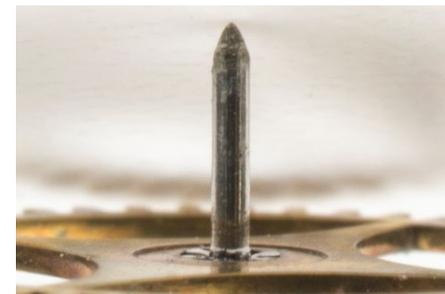
Figure 53: tigeon tailler en pointe roue de moyenne
