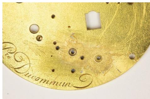
Figure 68: bouchon et étain retirés
