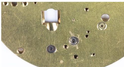
Figure 70: ancien bouchon coté intérieur de la platine
