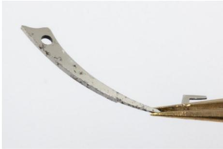
Figure 98: flanc du ressort avant
