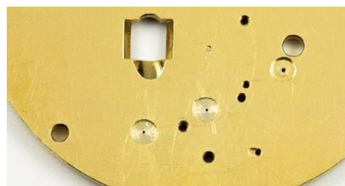
Figure 69: nouveau bouchon coté intérieur de la platine
