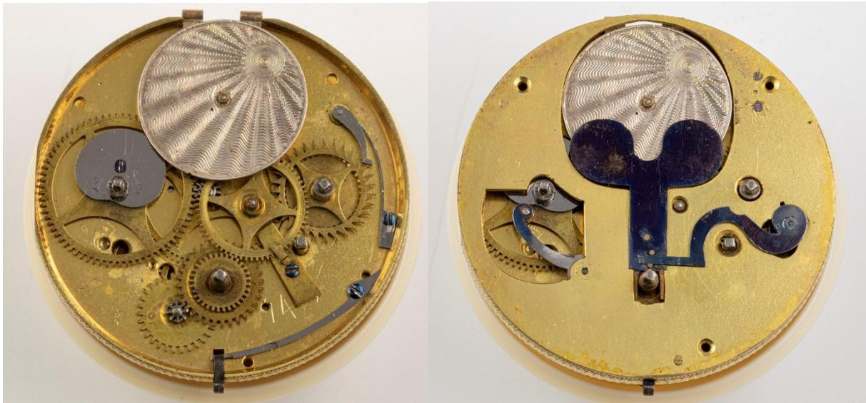
Figure 31 mécanisme du lever coucher du soleil
