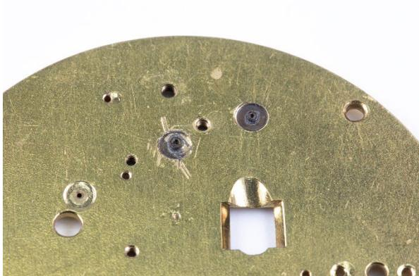
Figure 56: vue intérieure platine avec bouchon et étain
