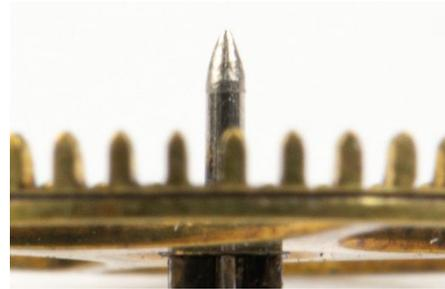
Figure 52: tigeon taillé en pointe roue de chant
