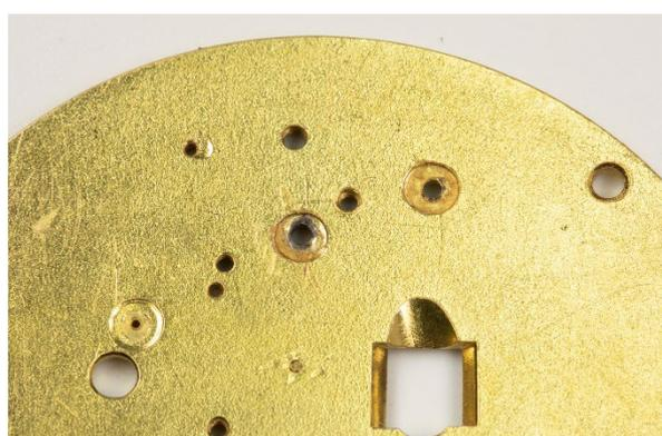
Figure 57: vue intérieure platine sans bouchon et étain
