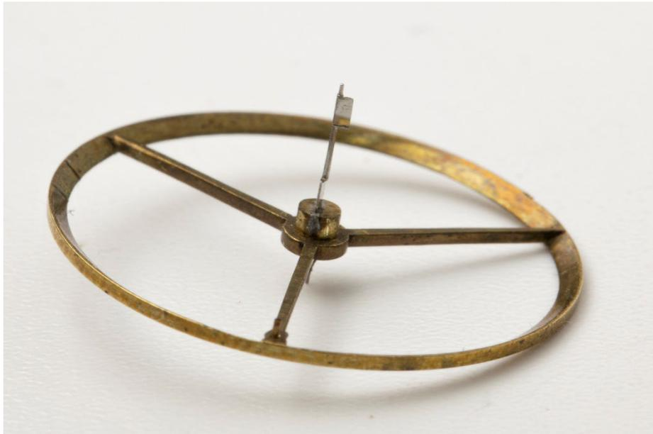
Figure 75: verge et balancier avant
