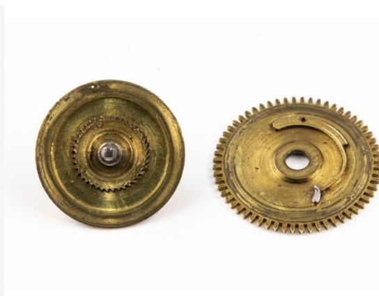
Figure 23: rochet et cliquet de la fusée
