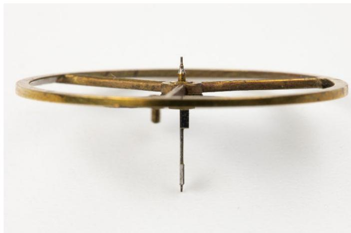
Figure 30: verge assemblée au balancier
