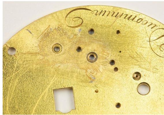
Figure 60: vue extérieure platine sans bouchon et sans étain
