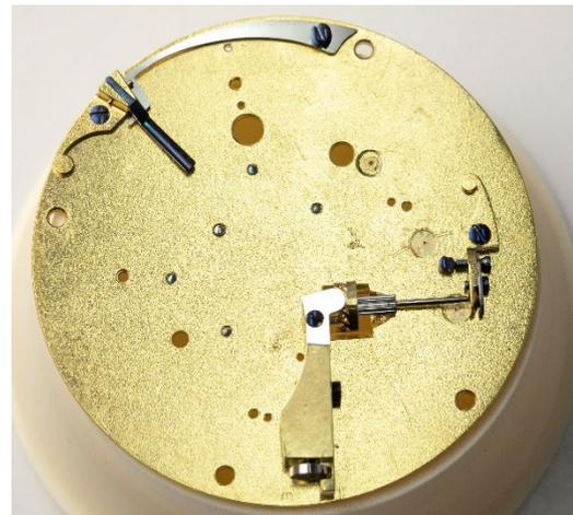
Figure 105 Mouvement lors de l'assemblage
